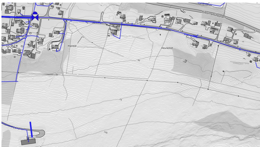
Figur 24 – Ny trykkreduksjonsventil på Plassane ved kum 713 og ny tappeleidning i Vabakken HB
